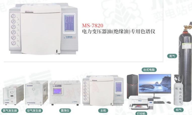
气相色谱法测定绝缘油中溶解气体的组分含量，是发、供电企业判断运行中的充油电力设备是否存在潜伏性的过热、放电等故障，以保障电网安全有效运行的有效手段，也是充油电气设备制造厂家对其设备进行出厂检验的必要手段。MS-7820 电力变压器油专用色谱仪采用国标推荐的三检测器流程，一次进样即可完成对绝缘油中溶解气体（包括  $H_2$ 、 $CH_4$ 、 $C_2H_4$ 、 $C_2H_6$ 、 $C_2H_2$ 、 $CO$ 、 $CO_2$ 、 $O_2$ 、 $N_2$ ）含量的全分析。
