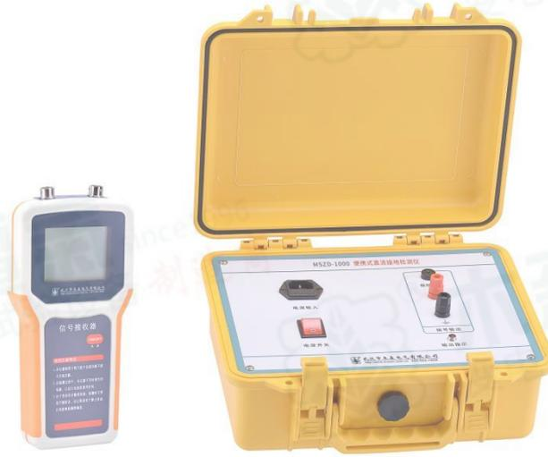
用于在不断电情况下查找发电厂、变电站直流系统接地点的准确位置。各种类型的接地故障，均能迅速地查找出接地点，准确率达到 100%。
