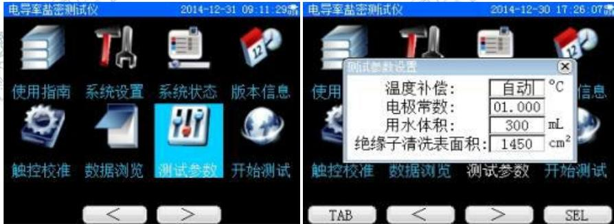
(1) 回到主菜单界面，按【▲】【▼】【<】【>】键移动光标到“测试参数”，按【OK】键进入“测试参数设置”界面；
