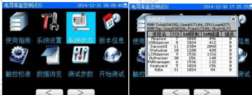
(8) 回到主菜单界面，按【▲】【▼】【<】【>】键，移动光标到“系统状态”，按【OK】键，仪器显示当前系统的状态，按【ESC】键，返回到主菜单；
