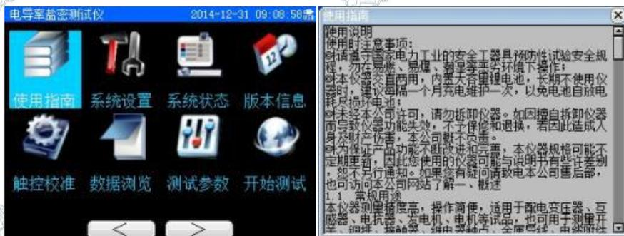
(1) 按下开关键【ON/OFF】，打开仪器。按【▲】【▼】【<】【>】键移动光标到“使用指南”，按【OK】键，仪器显示“使用指南”的详细内容，通过显示屏右边【▲】【▼】方向键浏览；
