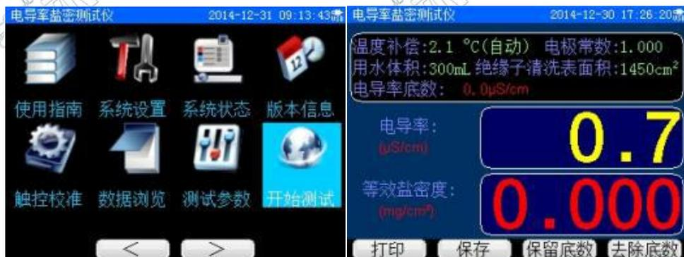
(1) 回到主菜单界面，按【▲】【▼】【<】【>】键移动光标到“开始测试”，按【OK】键进入“开始测试”界面；
