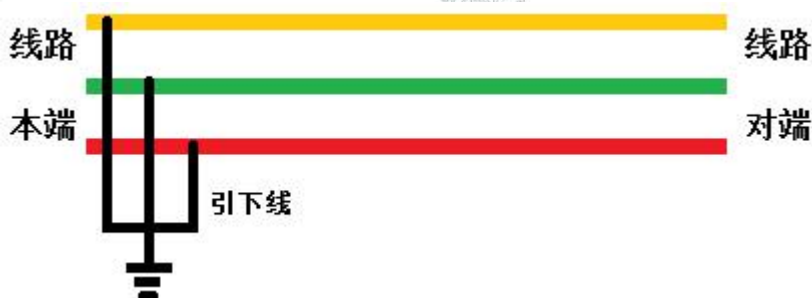
图 6-3 将被测线路本端引下线接地
