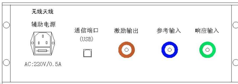
变压器绕组变形测试仪后面板图
