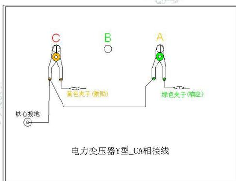
1. 测量系统共一点接地，取变压器铁芯接地。
