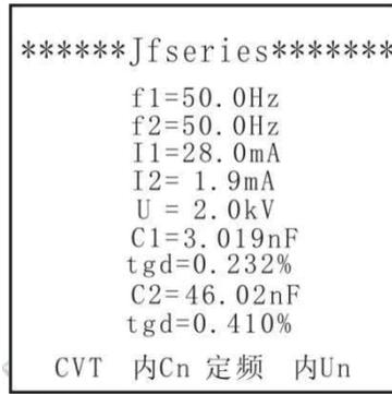
图8 测量电容C1和 $\text{tg } \delta_1$ 、C2和 $\text{tg } \delta_2$ 的接线      图9 CVT模式下打印结果
