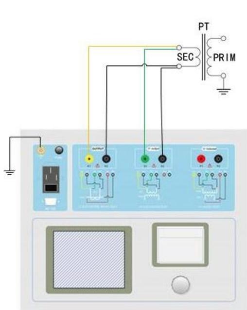
图2.7 PT直阻、励磁试验接线方式
