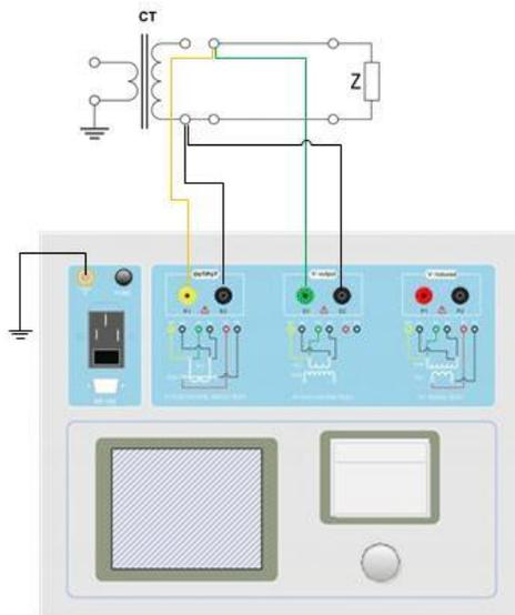
图 2 CT 直阻、励磁和变比试验接线方式      图 3 CT 负荷试验接线方式
