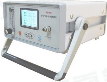
SF<sub>6</sub>分解物分析仪，通过同时监测 SO<sub>2</sub>、H<sub>2</sub>S、CO 三种分解物，能在现场快速地检测、判断 SF<sub>6</sub> 电气设备（断路器、互感器、变压器、GIS 和套管等）内部的早期故障。本仪器可广泛适用于电力、铁路、冶金和石化行业的 SF<sub>6</sub> 电气设备。
